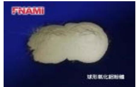
球形氧化鋁粉體 AIO-060-A1，平均粒徑約 6  $\mu\text{m}$ ，純度>99%(實測達 99.87%)、成球率>90%，為無毒之導熱耐熱填料，在電子陶瓷、拋光材料、高檔磨料、稀土元素三基色螢光粉、高壓鈉燈、透明陶瓷、陶瓷晶片、陶瓷纖維、人造寶石、催化劑載體等領域使用廣泛，也可用作微孔陶瓷、陶瓷過濾膜的原料，尤其適用橡膠、塑膠的填料，具有粘度低，流動性好，高填充，低磨損，高純度等特點。
